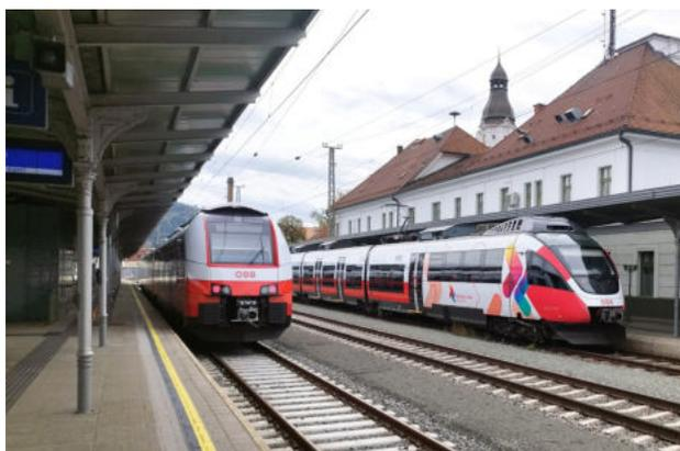
Elektrotriebwagen „Desiro ML“ (links) und „Talent“ (rechts).
