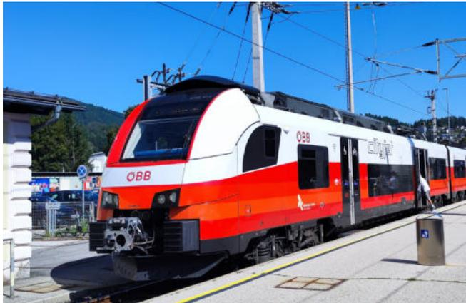
Ein „Desiro ML“ -Triebwagen auf der S-Bahn-Linie S2 im Bahnhof Feldkirchen in Kärnten
